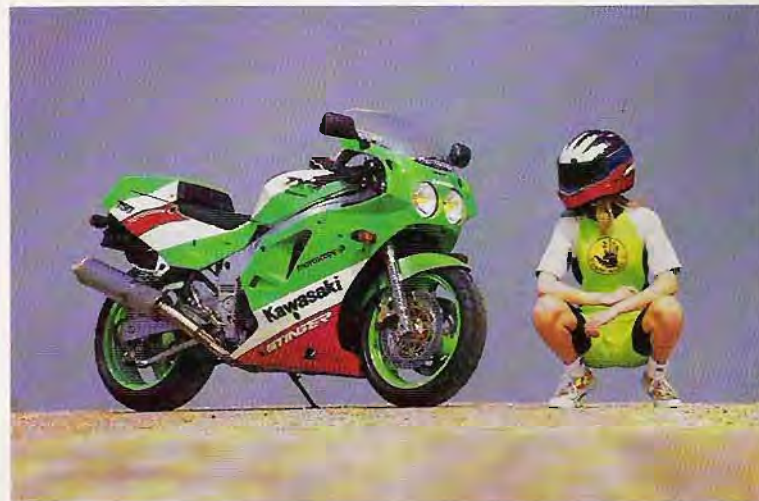
● La Stinger préparée par Motoscopy. Le concessionnaire s'est attaqué au moteur, obtenant un tempérament plus musclé. Possibilité de déco à la carte en option, mais il est vrai que sa robe d'origine convient parfaitement à l'esprit de la machine. Puissance estimée à 110/115 ch pour un poids identique.
