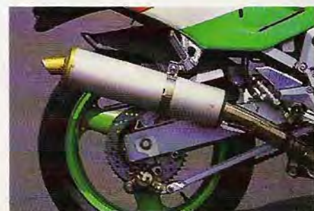
● En plus du silencieux maison, Motoscopy effectue une imposante modification sur le collecteur lui-même.
