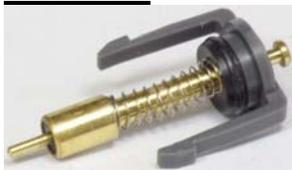
On trouve chez Triumph un kit starter pour BST36, composé du plongeur, ressort, joint, et carter plastic à clipser sur le carbu. Plongeur et ressort conviennent parfaitement à une BST34 !
