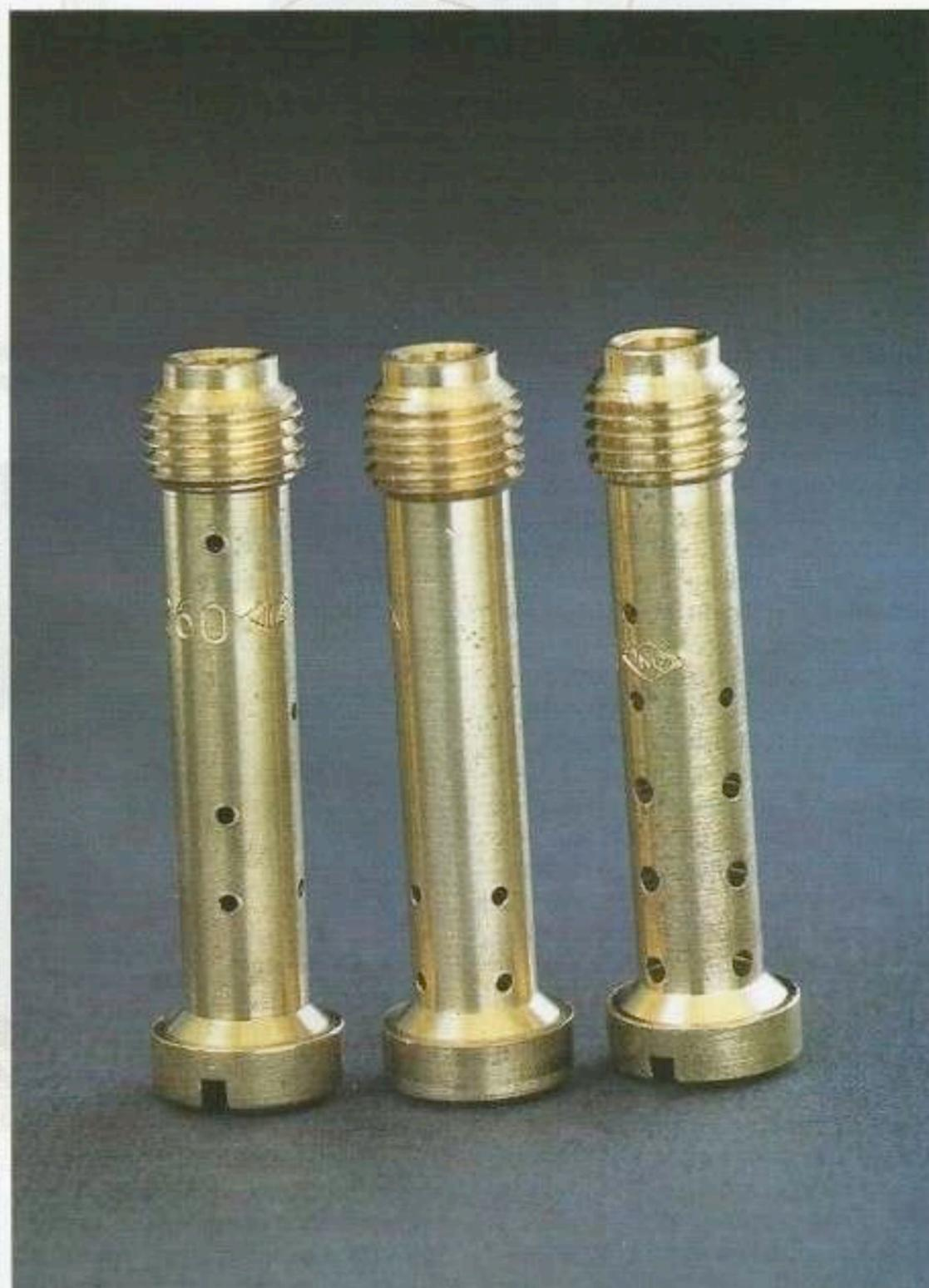
*Série de puits identiques par leur forme et le diamètre de l'orifice calibré, mais différents par le perçage du petit tube.*
