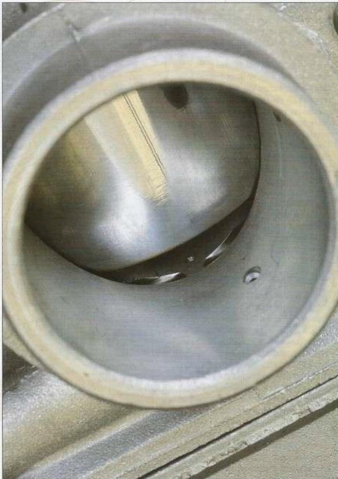
*Le boisseau étant partiellement soulevé, nous pouvons observer la disposition de l'orifice de progression.*
