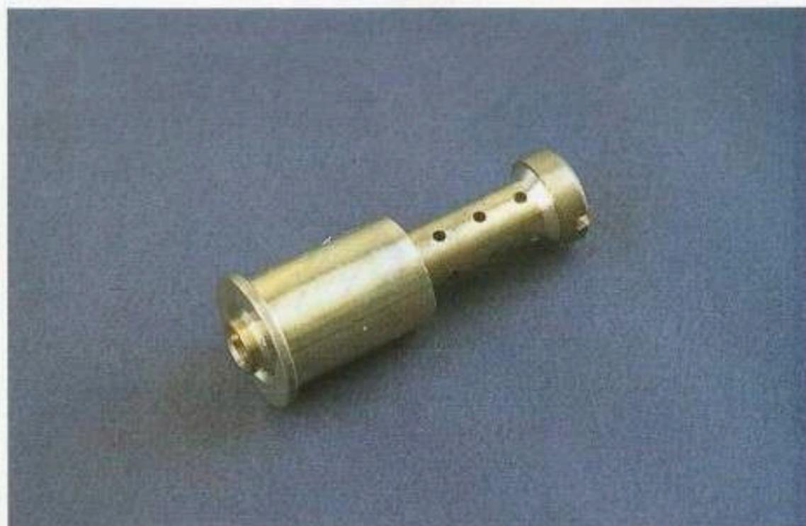
*Puits de type quatre temps avec le puits monté à l'intérieur du gicleur qui le maintient en place dans le corps carburateur.*
