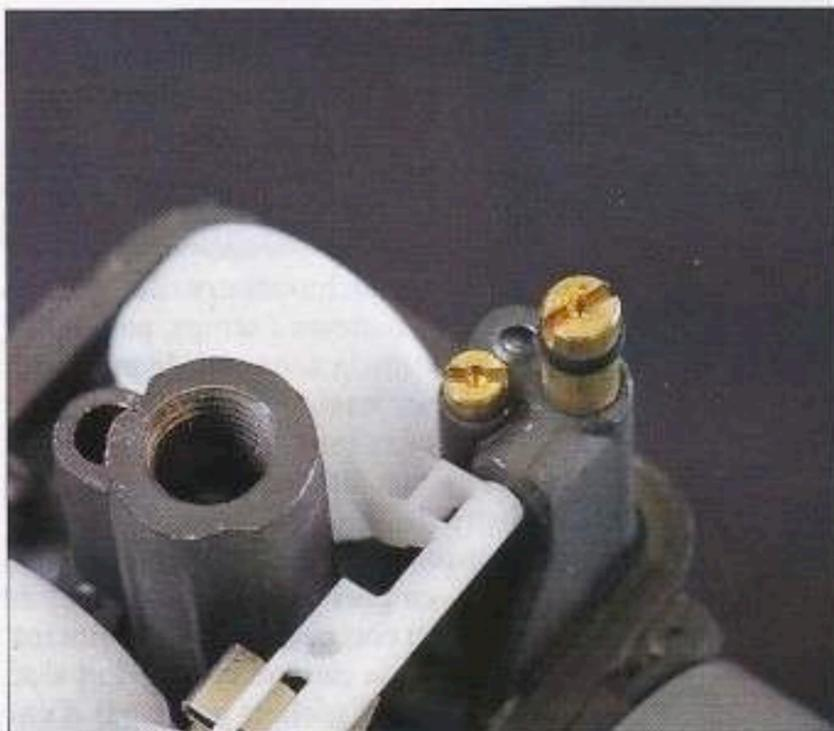
*Le gicleur principal monté dans la cuve d'un Dell'Orto PHBH à côté du gicleur de démarrage.*
