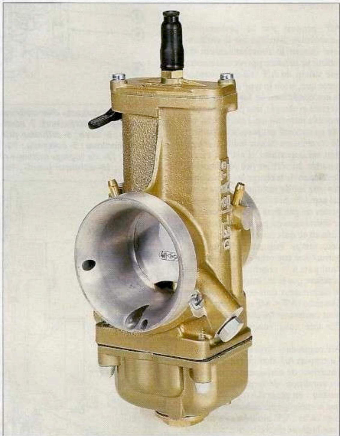
1. contrôler la puissance développée par le moteur en réglant le débit d'air admis selon les ordres du pilote ;
