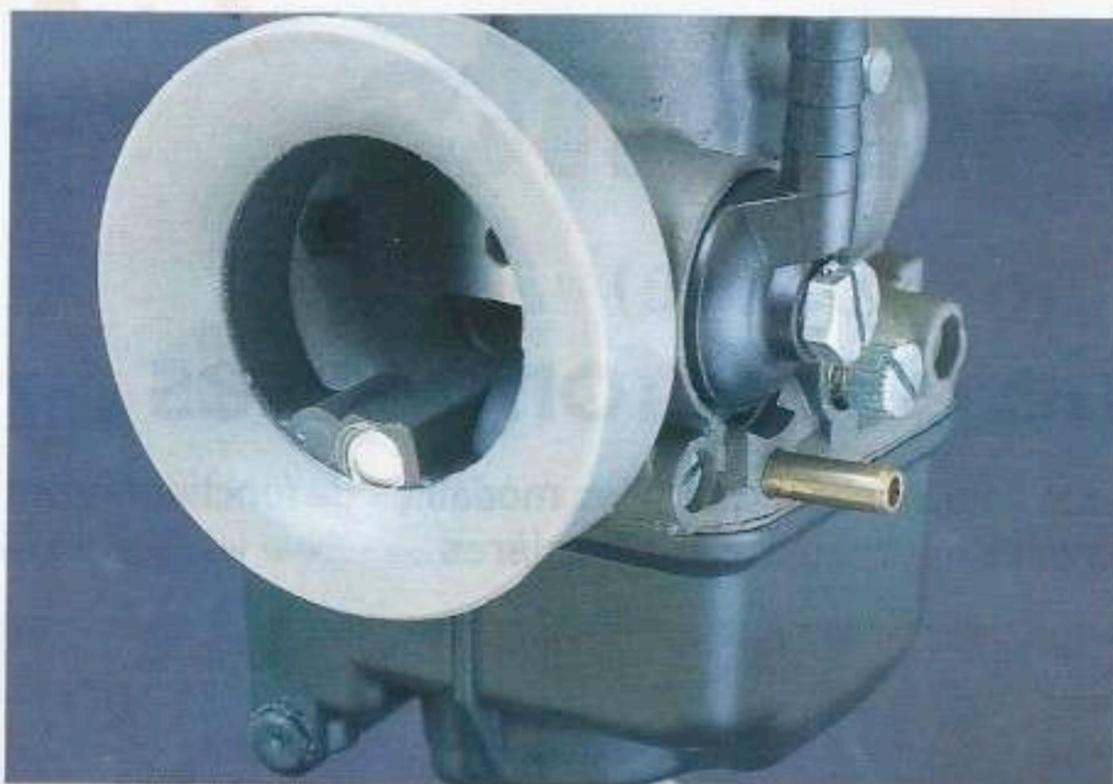
*Pour éliminer l'influence des variations de pression que l'on a dans la boîte filtre, l'air du circuit principal est parfois aspiré à l'extérieur au moyen d'une liaison dont nous voyons le petit tube d'alimentation sur la droite du carburateur. Dans ce cas, l'orifice dans le conduit d'air est fermé par un bouchon.*
