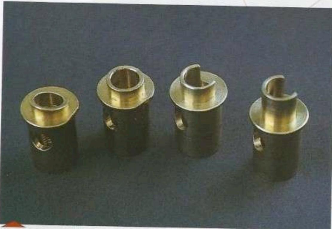
Même type avec quatre configurations différentes du socle du gicleur qui fait saillie à l'intérieur du puits.
