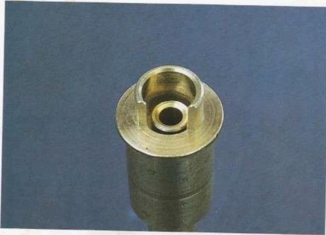
Puits de type deux temps avec une vue de dessus du gicleur qui entoure le véritable puits.
