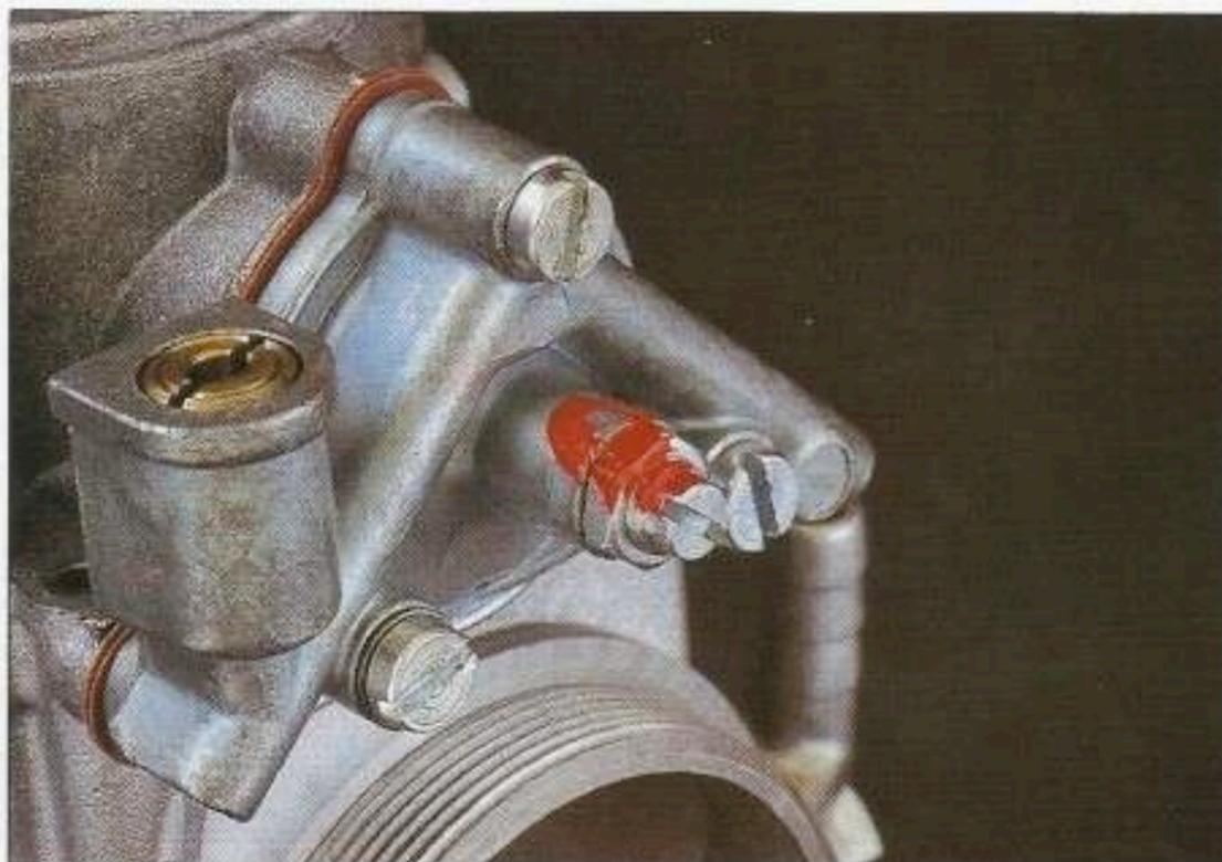
*Détail de la vis de réglage de la pompe qui permet de réguler le débit distribué : en la vissant on diminue le débit, en la dévissant on l'augmente.*
