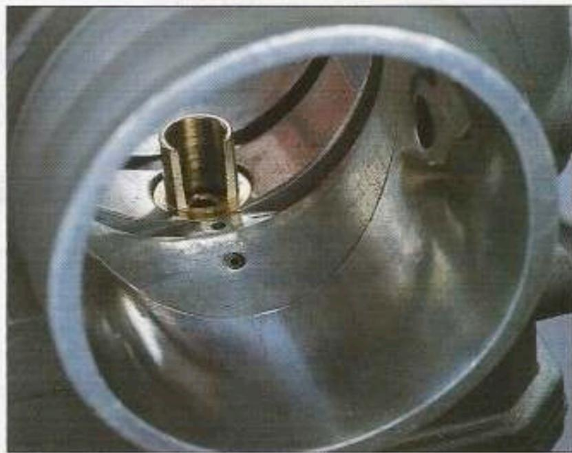
*Gros plans de deux orifices de diffusion du circuit de ralenti (au premier plan) et de celui de progression, visible immédiatement en amont du pulvérisateur. Nous pouvons remarquer que l'orifice de progression se trouve dans tous les cas sous le boisseau et que sa distance par rapport au gicleur principal dépend de la forme du boisseau lui-même (cylindrique, à gauche, ou bien plat, à droite).*
