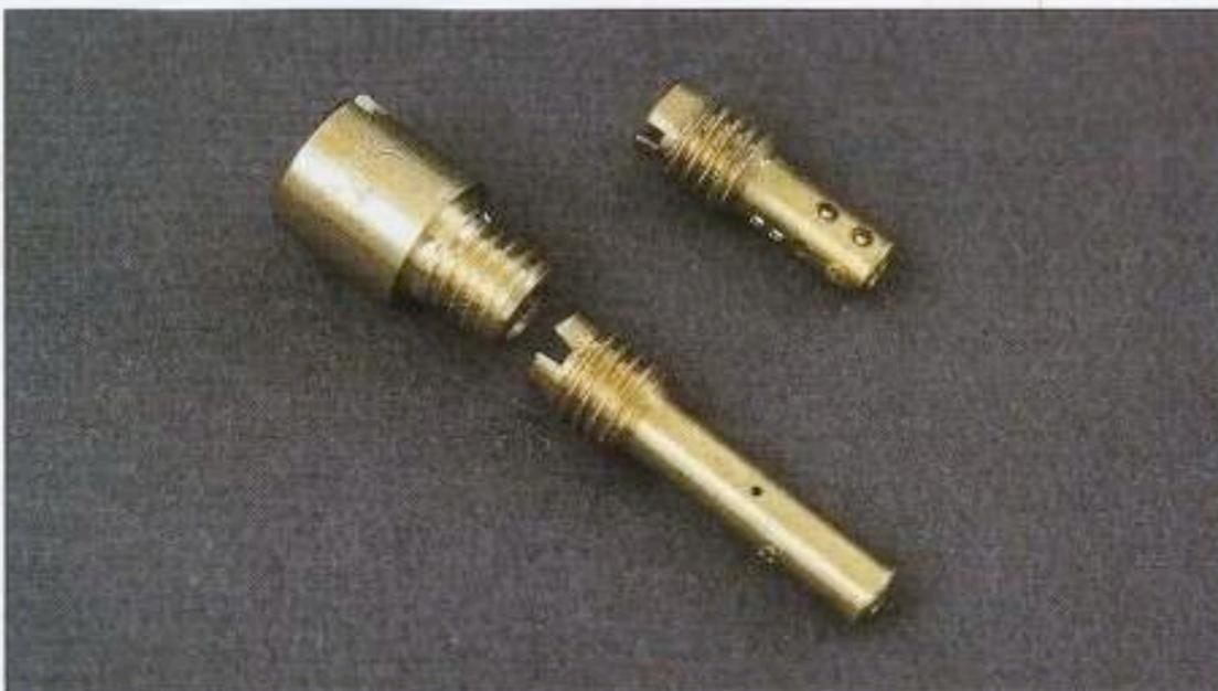
*Deux dispositions possibles de gicleurs de ralenti : l'élément de réglage peut être unique et usiné dans la pièce même du tube émulseur, ou bien peut être constitué par deux éléments séparés, dont le second est l'émulseur gicleur qui travaille en série avec le premier pour maintenir une plus grande quantité de liquide sur le passage calibré.*
