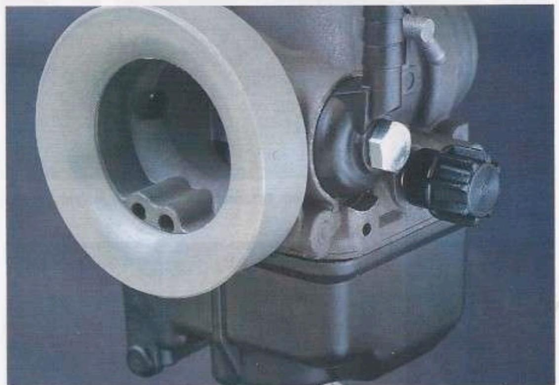
Le circuit principal est également alimenté par l'air qui va émulsionner le carburant dans le puits (quatre temps) ou dans le gicleur (deux temps). La prise de l'air du circuit principal se trouve d'ordinaire dans la prise principale sur l'embouchure du carburateur, comme nous le voyons dans cette illustration ; le second orifice est celui de l'air de ralenti.
