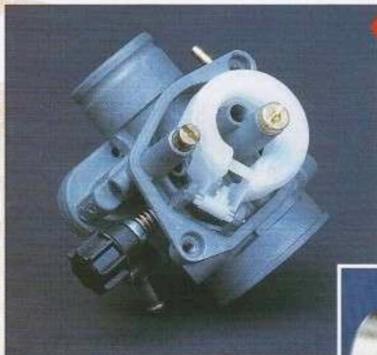
Type de flotteur annulaire, dont la section est bien visible : 1- prise air cuve ; 2- flotteur ; 3- raccord ; 4- conduit arrivée combustible ; 5- pointeau.
