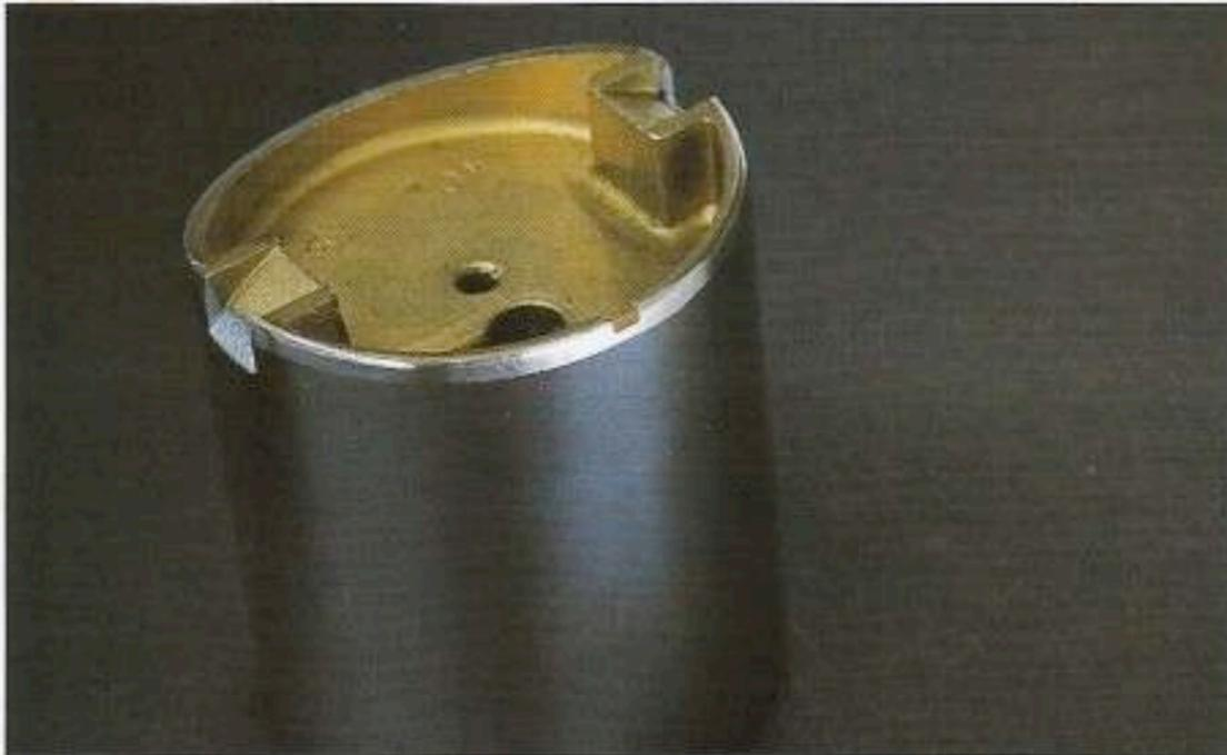
*Boisseau avec une encoche sur le bord postérieur, qui sert à diriger le flux d'air sur l'orifice de ralenti avec la commande de gaz fermée.*
