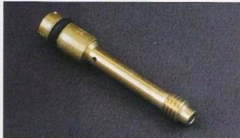
*Gicleur de démarrage qui comprend également un petit tube émulseur, dans lequel l'air entre par les orifices pratiqués près du filetage.*
