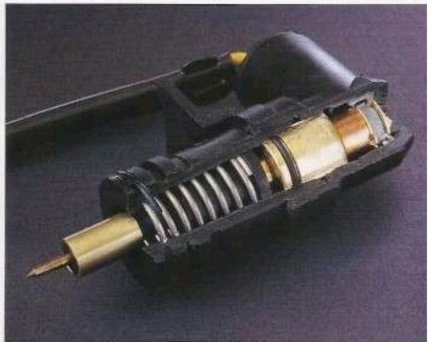
*Section d'un starter automatique Dell'Orto : on peut voir l'enroulement qui réchauffe l'élément thermo-sensible qui, à son tour, actionne la soupape de fermeture du circuit.*
