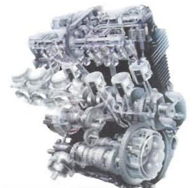
Cette vue « éclatée » du moteur de la CBX permet de visualiser le report de l'alternateur à l'arrière du bloc-cylindres. Grâce à des pipes incurvées, les carburateurs latéraux sont déportés vers l'intérieur pour ne pas gêner les jambes du pilote.
