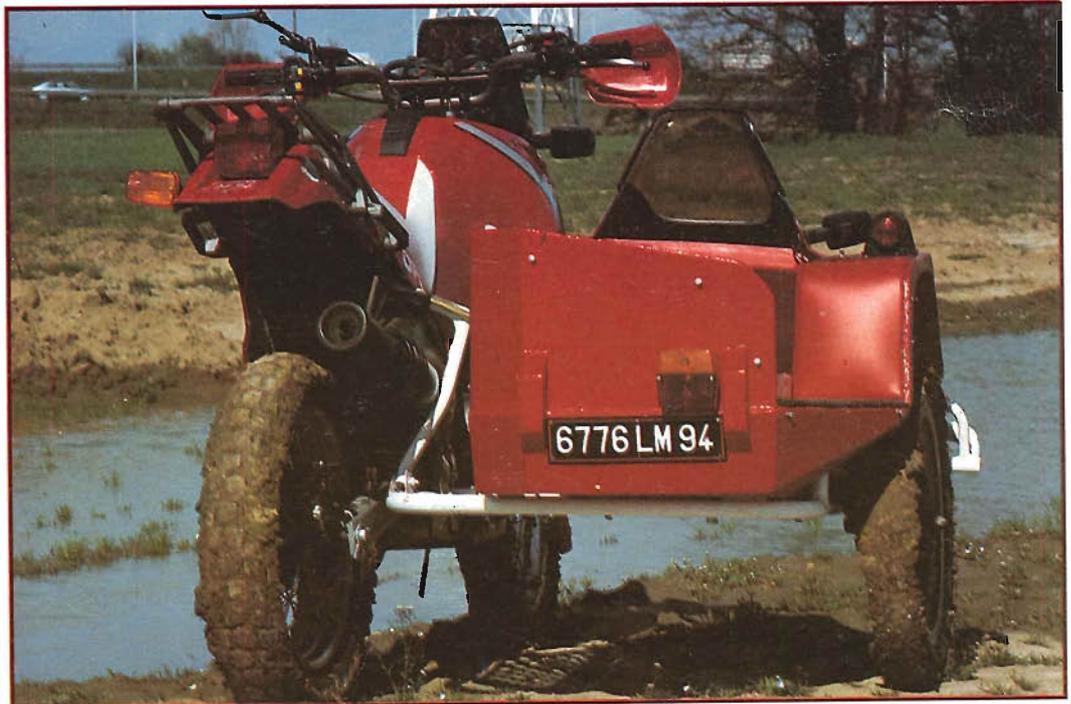
*Terrain de prédilection: la boue. A noter la modification de la carrosserie arrière du DR. Un grand garde-boue plastique assure l'étanchéité du feu jusqu'au bras oscillant.*
