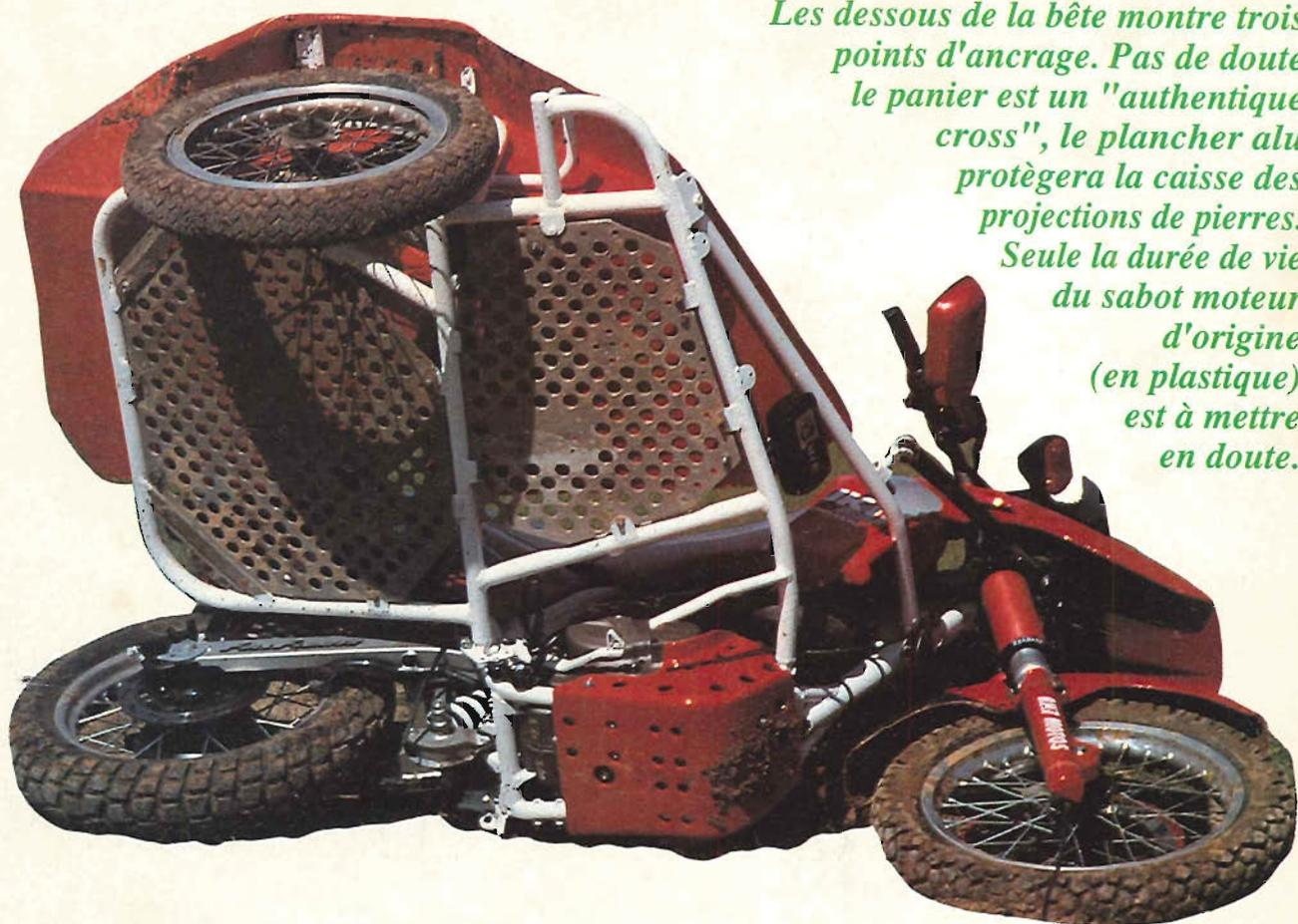
*Les dessous de la bête montre trois points d'ancrage. Pas de doute le panier est un "authentique cross", le plancher alu protégera la caisse des projections de pierres. Seule la durée de vie du sabot moteur d'origine (en plastique) est à mettre en doute.*
