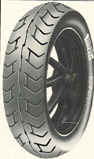
et piste sur véhicules à haute puissance d'accélération et aux caractéristiques de conduite sportive. Les véhicules en question sont caractérisés par un montage en premier équipement de jantes larges (3.50 à l'avant et 5.50 à l'arrière) et avec des pneus radiaux.
