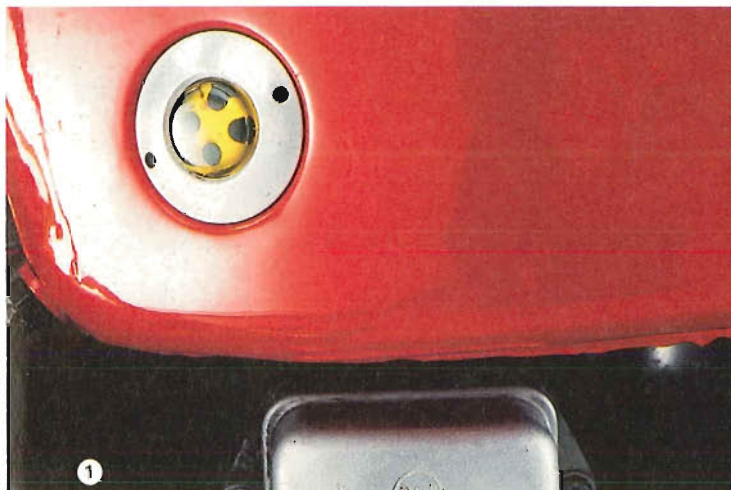
1 Nouvelle chez Jawa, la Californian est pourvue d'un graissage séparé : plus besoin de trimballer son bidon d'huile ! 2 Les pots relevés, ce n'était pas encore la mode, mais l'initiative des dessinateurs donne une petite touche agressive, d'ailleurs la recette a été largement utilisée jusqu'à nos jours.
