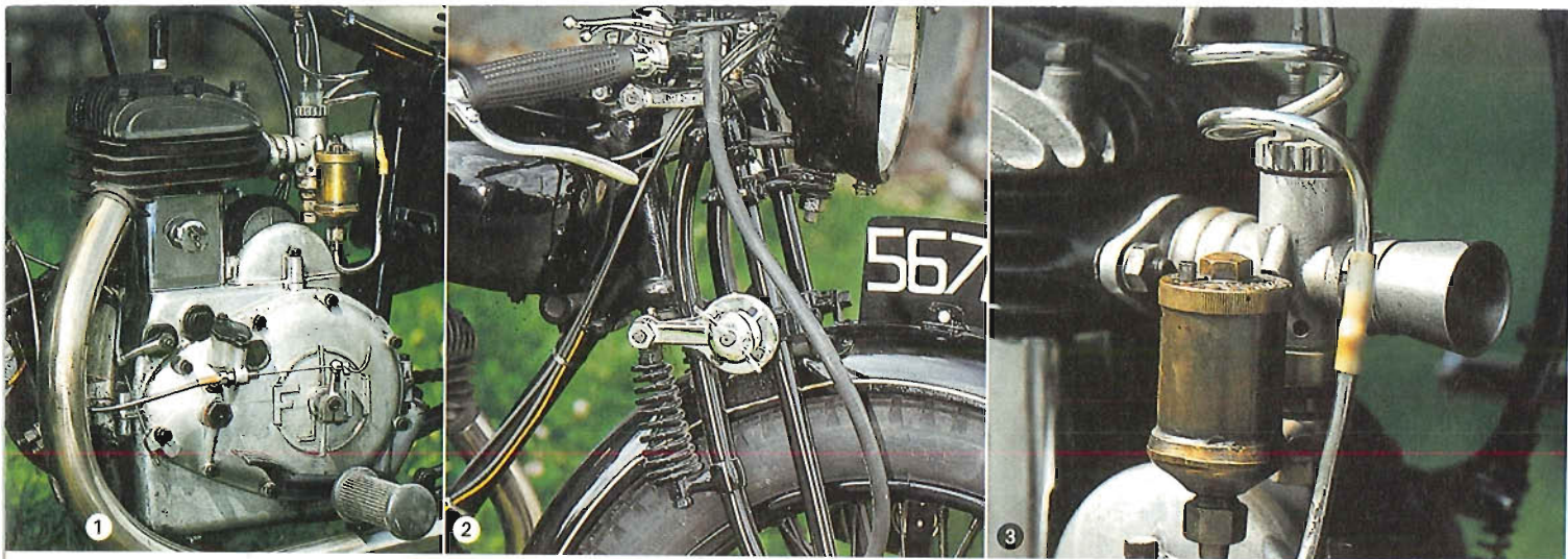
❶ La trappe carrée sur le cylindre cache les soupapes latérales, tandis que le levier au centre du carter commande l'embrayage et celui de gauche le lève-soupape. ❷ Les ressorts de la fourche à parallélogramme travaillent en compression et l'amortissement est confié à des disques à friction. ❸ La canalsation d'essence en métal est interrompue par un tuyau plastique pour éliminer les effets destructeurs des vibrations.
