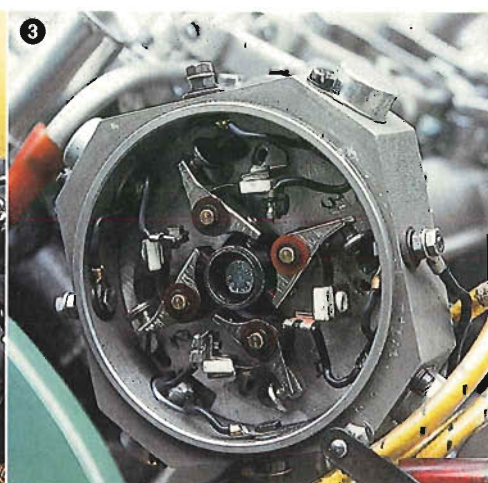
1 Le thermomètre de température d'eau trahit le refroidissement liquide du V8. 2 Cette vue plongeante met bien en évidence la complexité mécanique du moteur V8 avec ses quatre ACT et sa batterie de huit carburateurs. 3 Les deux allumeurs sont entraînés par les deux arbres à cames d'admission. Chaque allumeur comporte quatre jeux de rupteurs, un par cylindre. Imaginez le "coup de patte" nécessaire pour un simple réglage d'allumage !
