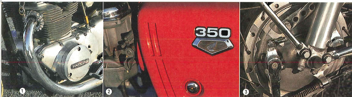
❶ Le moteur du best-seller CB 350 a bien des atouts pour plaire aujourd'hui encore, à commencer par sa "belle gueule". La visserte BTR est une amélioration "comme à l'époque", qui remplace avantageusement la cruciforme. ❷ La CB existe en 250 comme en 350, il n'y a guère que le sigle sur le cache latéral pour différencier les deux modèles. Mais évidemment seule la 350 apparaît dans les chiffres de vente. ❸ Plutôt esthétique, c'est le frein avant double-came qui date vraiment la moto pour une utilisation actuelle : efficacité parfois "limite" !
