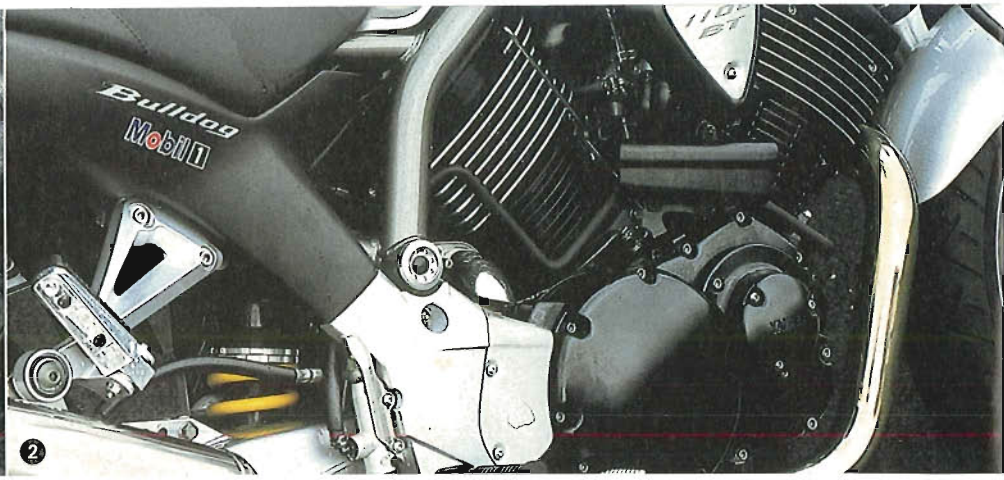
❶ Le redoutable freinage de la très sportive R6 est très efficace... presque trop pour un sage roadster. ❷ Le bicylindre en V a été revu, mais on note surtout une belle finition de cette moto : platines, traitements de surface sont du meilleur niveau.
