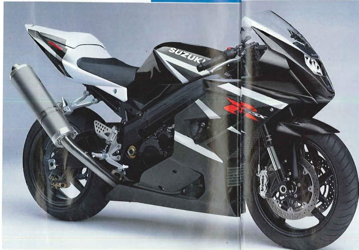
La GSX-R imaginée par Martin Boré préfigure peut-être le modèle 2004 : découpe acérée du nez et des flancs de carénage, bras oscillant renforcé, étriers Brembo, pot d'échappement relevé, arrière de selle encore plus effilé... En plus, elle est en version racing, sans rétro, clignos ni bavette ! A gauche : la GSX-R du SERT.
