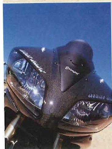
La tête de fourche et la coque avec passage de roue sont réalisées en fibre de carbone. Elles ajoutent à l'agressivité naturelle de la R1. Superbe ! Comptez 2 800 € la carapace high tech.
