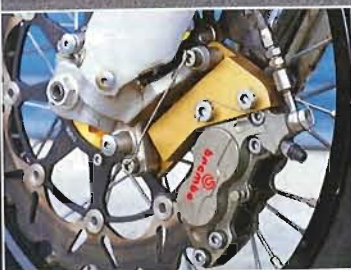
Etrier Brembo racing, disque flottant wave en 320 et jante Excel (3,5) montée sur moyeu Talon.
