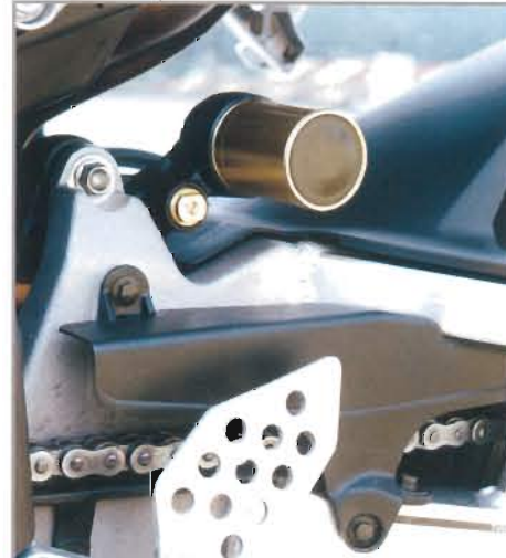
Depuis 2003, l' AMORTISSEUR n'a plus aucune liaison avec le cadre (système Unit Pro Link).
