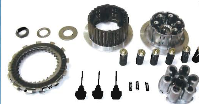
Eclaté de l'embrayage APTC (sans la cloche). Les commandes de l'embrayage sont plus souples grâce à l'utilisation de ressorts moins durs.
