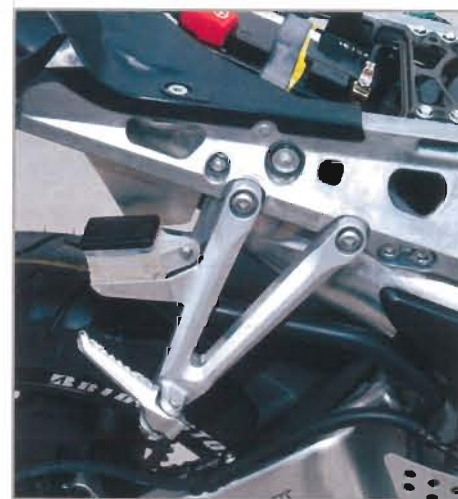
La BOUCLE ARRIÈRE bénéficie du même procédé de moulage utilisé pour le cadre.
