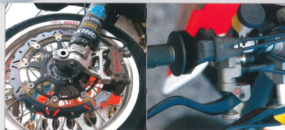
Le DISQUE BRAKING WAVE est pincé par un étrier Brembo à fixation radiale, monté sur une fourche Marzocchi de 48 mm.
