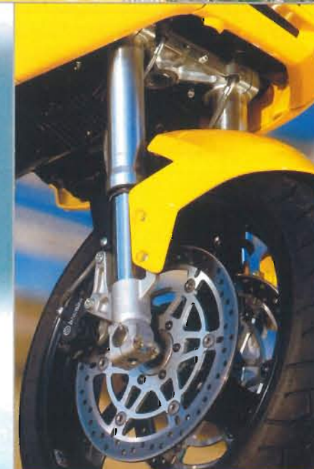
La 620 Multistrada bénéficie d'une fourche inversée Marzocchi de 43 mm et de deux disques de 300 mm. La version Dark dispose, elle, d'un simple disque de 320 mm et pincé par un étrier Brembo 4 pistons.
