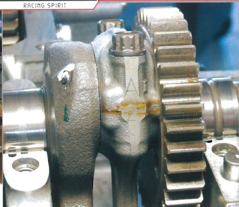
▲ Les BIELLES possèdent leur propre code : A code poids, 2 code alesage.
