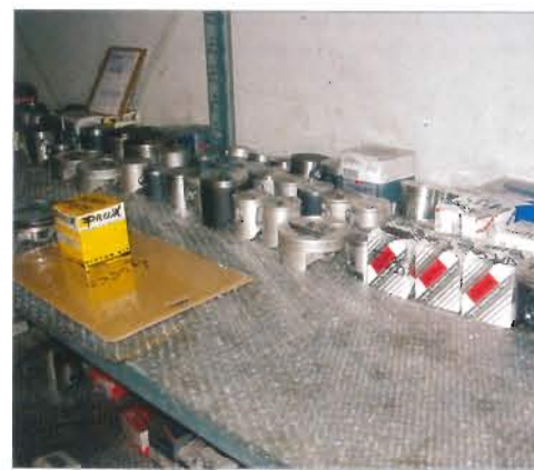
Sur cette étagère on stocke LES PISTONS dont les cylindres sont en traitement. Au départ du processus, ils ont été repérés par un marqueur indélébile. Les cylindres sont gravés, et tout est archivé sur un cahier pour être ensuite reporté sur informatique, où l'on peut retrouver le suivi des pièces 10 ans après.
