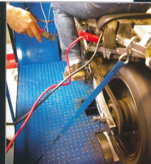
La lampe stroboscopique permet de visualiser la déformation du pneu en fonctionnement.
