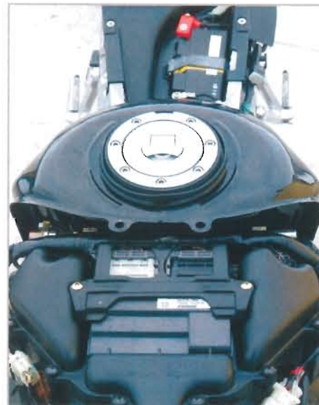
Le RÉSÉROIR est très court et descend bas derrière le moteur. Ceci en vue de recentrer les masses.
