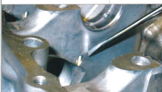
▲ Détail de conception : juste au-dessus des paliers de vilebrequin se trouvent de PETITS GICLEURS qui vaporisent de l'huile sur les parois du cylindre.
