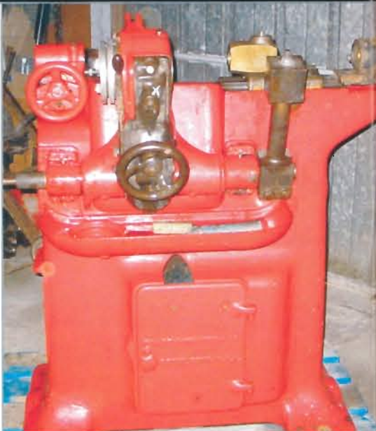
On est ici devant une rectifieuse d'arbres à cames des moteurs en étoile des forteresses volantes. Cette machine doit être présentée à Retromobile.
