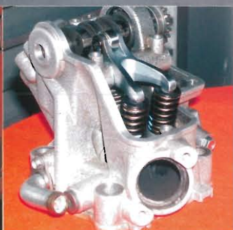
La culasse comporte un MOTO À CAMES et 4 soupapes en titane.
