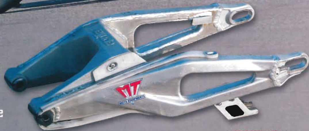
Le BRAS OSCILLANT allie aluminium extrudé et moulé
