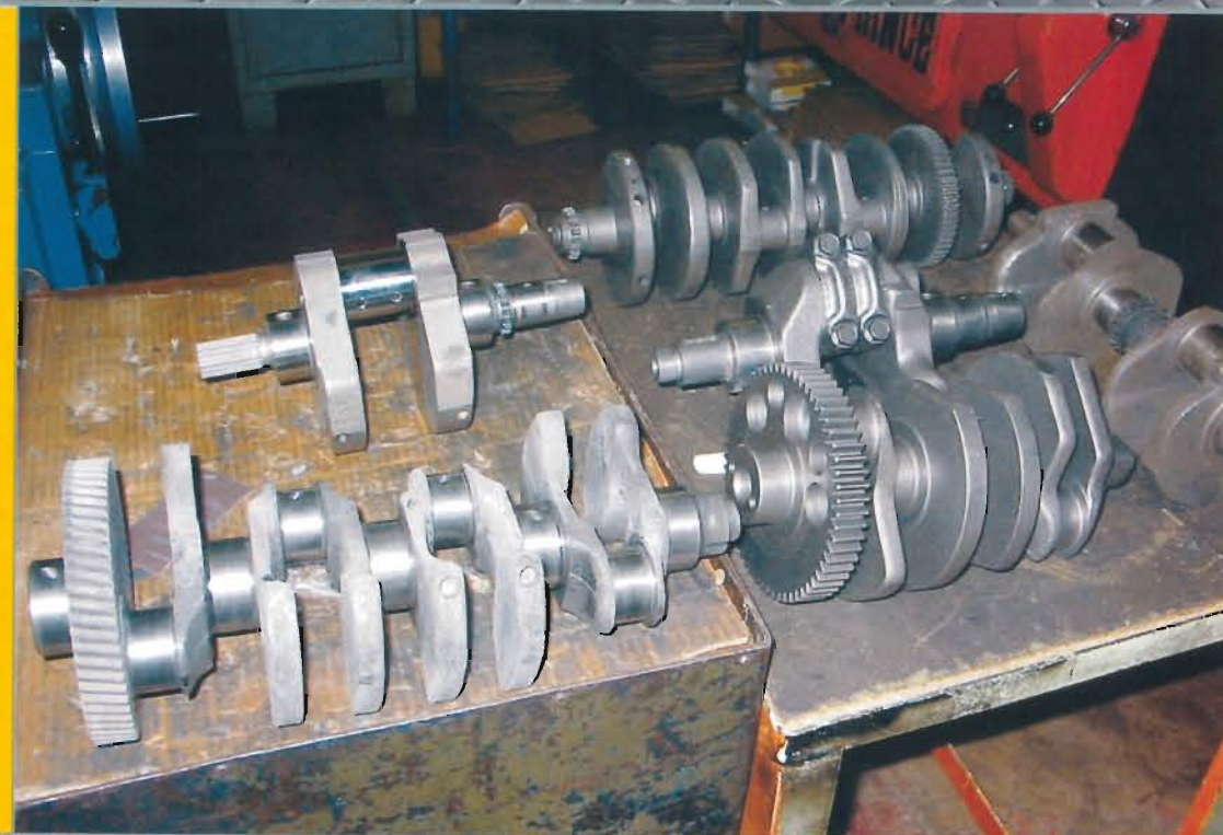
1 Cette vitrine recèle des trésors : un bloc moteur de 600 YZR d'usine, à côté d'un vilebrequin de V8 Cosworth en bas. Au-dessus, un échantillon de bielles de Formule 1 V12 Matra avec un arbre à cames. Vilebrequin de V10 de FI. Dans le fond, on distingue un cylindre culasse monobloc de moteur d'avion en étoile.
