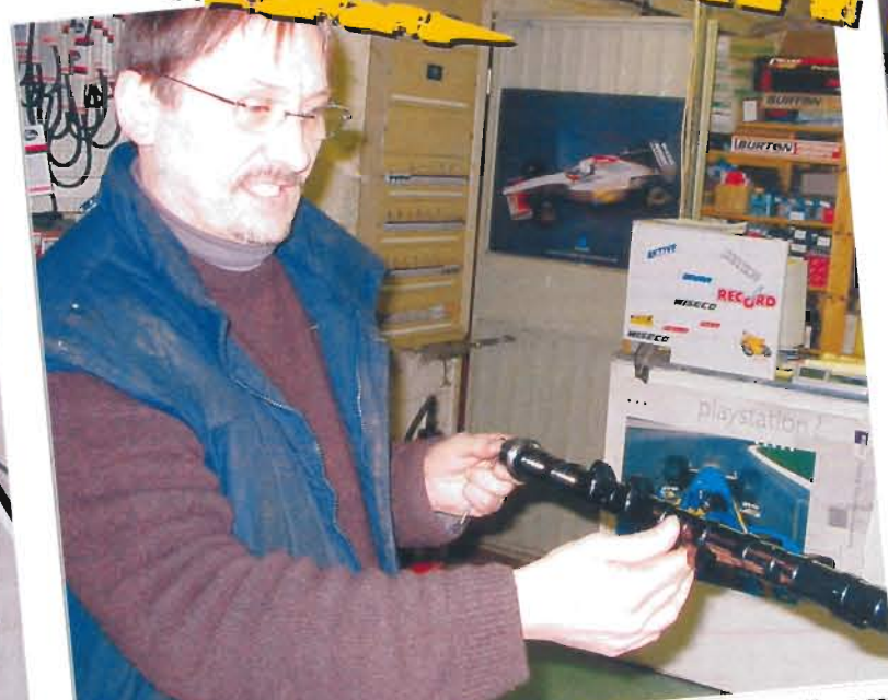
LAURENT VERSYP a eu sa première équilibreuse à 13 ans, son premier tour à 15 ans. Il nous montre un arbre à cames de FI revêtu d'un carbone amorphe, à base de diamant : c'est ce qu'il y a de plus moderne en matière de revêtement antifriction.
