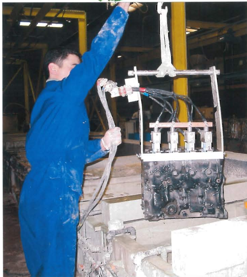
Voici l' ARRIVAGE DE LA JOURNÉE . De gauche à droite, des cylindres de Porsche, de Husqvarna (au premier plan), des pistons plats. Certaines pièces sont fortement abîmées et le revêtement est tellement usé que l'on voit apparaître l'aluminium.
