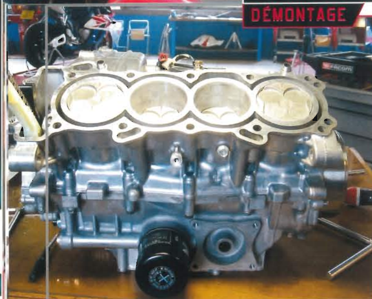
▲ Le bloc cylindre est du type OPEN DECK . Les chemises sont insérées lors du moulage de l'ensemble du bloc.
