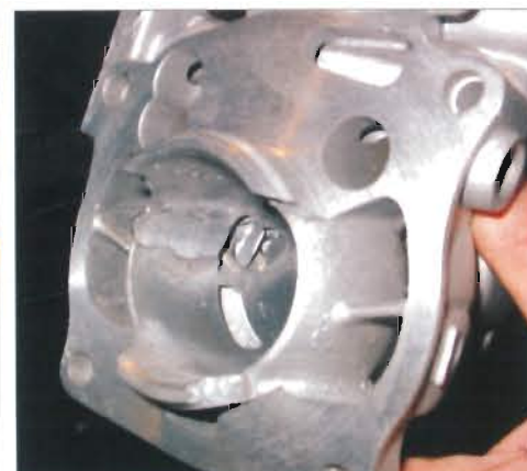
Voici un CYLINDRE 2 TEMPS de retour de soudure. La soudure d'un cylindre aluminium, une fois débarrassé de son revêtement, ne pose pas de problème. Actuellement, ce travail est sous-traité.
