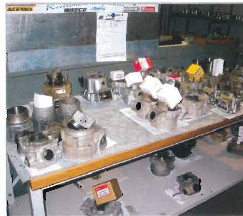
Voici l' ARRIVAGE DE LA JOURNÉE . De gauche à droite, des cylindres de Porsche, de Husqvarna (au premier plan), des pistons plats. Certaines pièces sont fortement abîmées et le revêtement est tellement usé que l'on voit apparaître l'aluminium.
