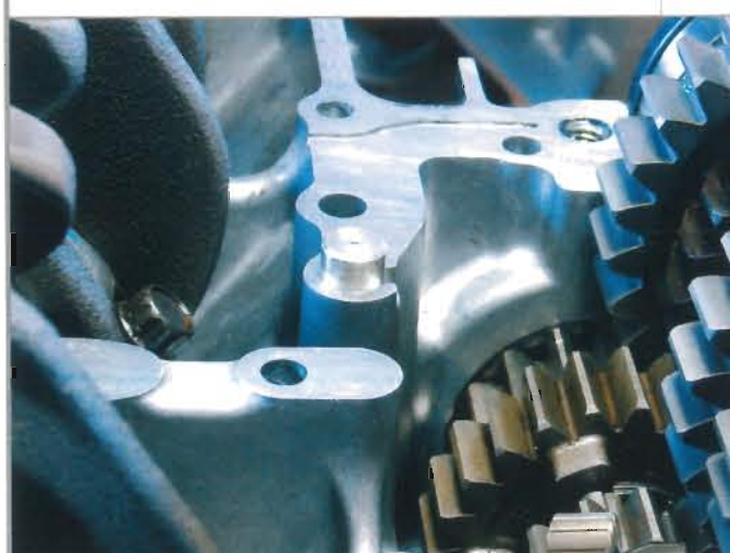
▲ Détail de conception : ce GICLEUR permet de vaporiser de l'huile sur les rapports 5 et 6, qui sont les plus sollicités.
