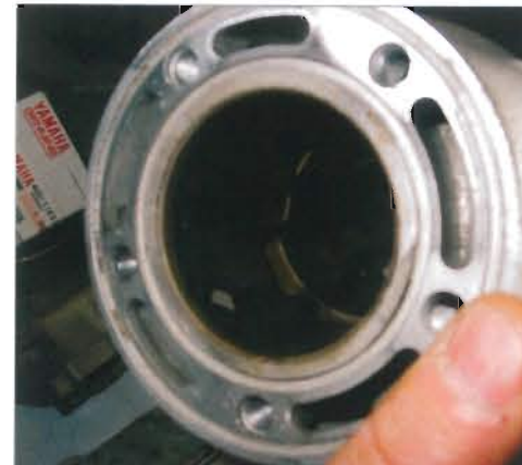
Voici un CYLINDRE DE 250 YZ YAMAHA avec une entaille profonde. Il va falloir le souder. Ensuite le cordon de soudure sera arasé à la cote nominale, puis le cylindre suivra le circuit de traitement.
