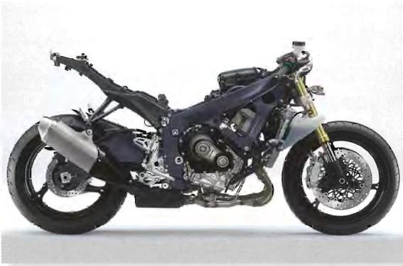
Moteur centré dans le châssis aluminium à longerons, avant ramassé, arrière relevé... la Suzuki 750 GSX-R adopte la structure d'une moto hypersport moderne.
